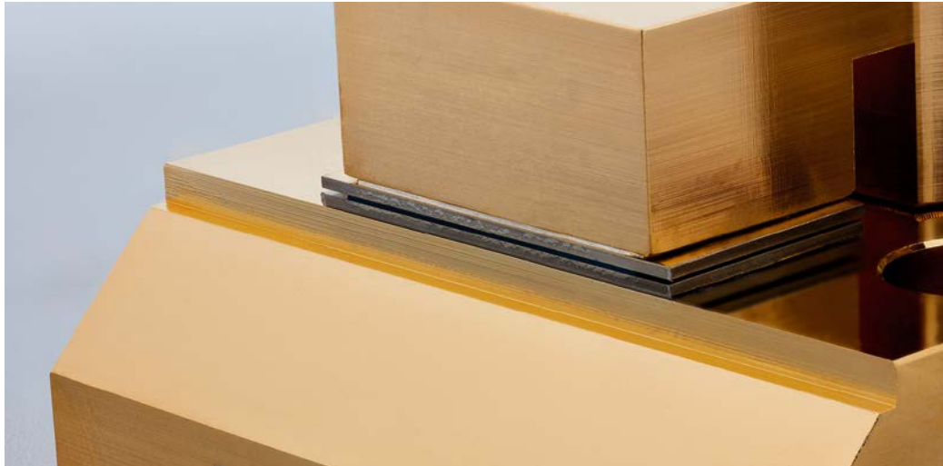
Laserbarren der Kilowatt-Klasse zum Pumpen von Festkörperlasern.
